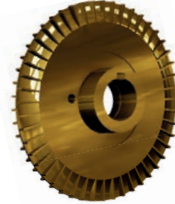
Laufrad aus Messing mit radialen Schaufeln. Hohe Förderhöhen auch bei geringen Fördermengen.
